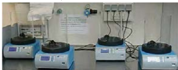
Рис. 2: четыре ротаметра, настроенных для высокопроизводительного скрининга, позволяют одновременно тестировать нескольких животных
